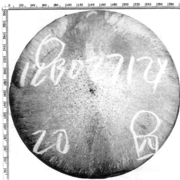
图 1 Φ300 mm 圆铸坯低倍中间裂纹, 0.5 级
